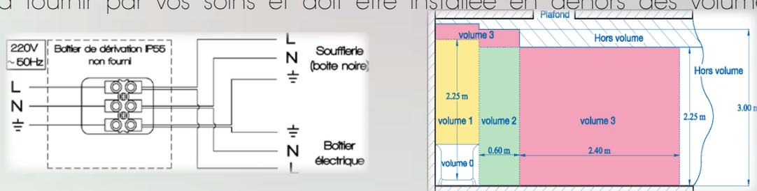
A partir de votre boîtier de dérivation étanche, raccordez un câble de terre supplémentaire d'une section minimale de 2,5 mm<sup>2</sup>, à la borne équipotentielle.
