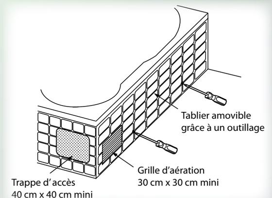
**ATTENTION: L'habillage de la baignoire doit toujours permettre l'aspiration d'air nécessaire au bon fonctionnement du système, ces différentes prises d'air ne doivent en aucun cas se faire en extérieur (du bâtiment) ni par le vide sanitaire.**
