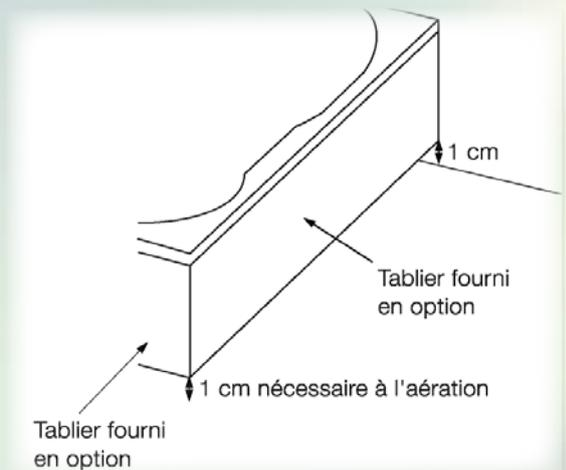
En cas de création, votre tablier doit être installé de façon fixe, démontable à l'aide d'un outil et disposant d'une trappe de grande dimension (40 cm x 40 cm minimum) permettant de créer cet accès facile à toutes les parties du système.
