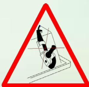
La baignoire ne doit subir aucune modification (sciage, meulage de renfort, déplacement de pompe ...) autre que le perçage pour robinetterie.
