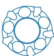
Le variateur d'air permet de régler la puissance des jets en sortie de buses grâce au procédé Venturi basé sur un apport d'air au circuit d'eau. Si vous souhaitez un massage à pleine puissance, le variateur d'air doit être dévissé et inversément afin d'obtenir la puissance de massage désirée.
