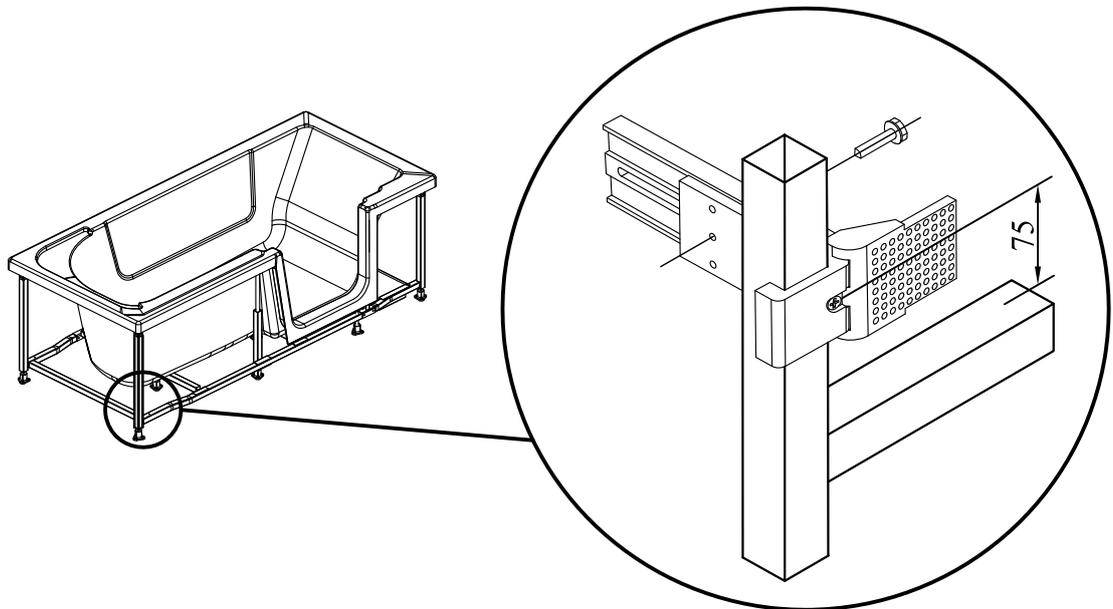
B/ Positionnement sur pied central du système de fixation + équerre :
