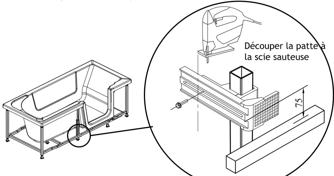
C/ Positionnement sur pied sous tête du système de fixation + équerre :
