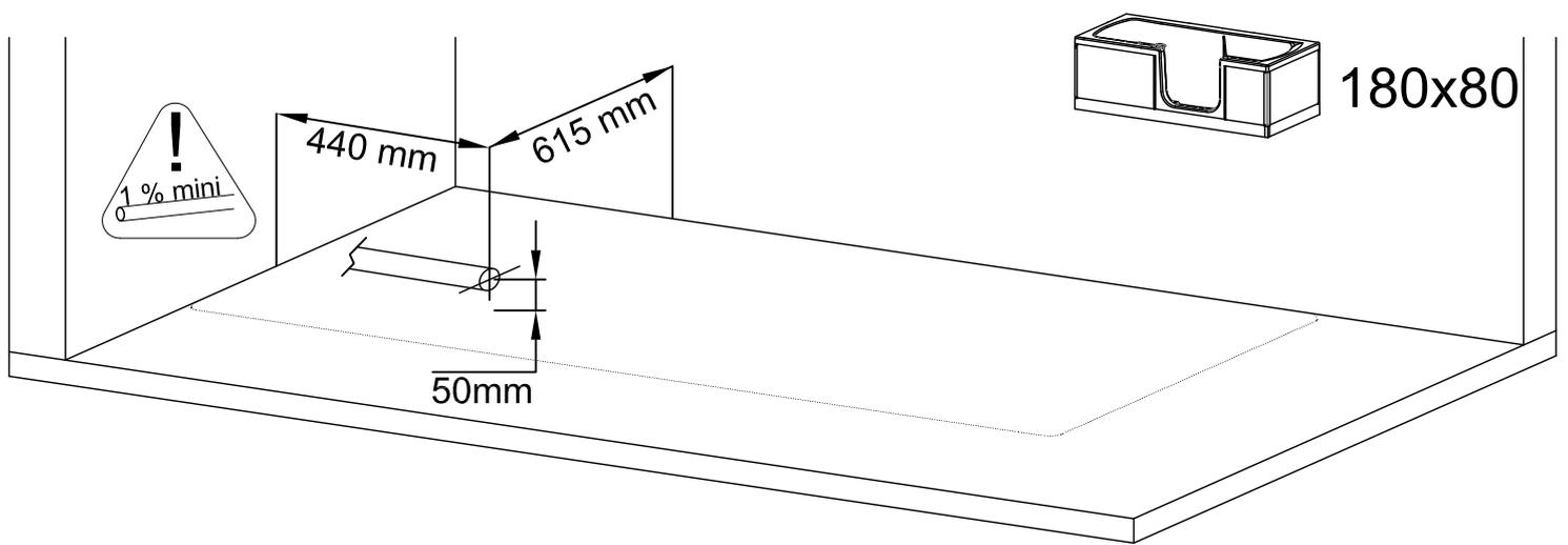
Mettez en place votre évacuation et raccordez un raccord souple de 20 cm (obligatoire pour absorber les vibrations et préserver votre installation).
