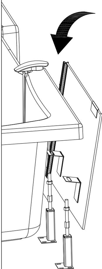
A l'aide des écrous de réglage, positionnez les équerres de façon à ce que le tablier dépasse de 10 mm du retour de baignoire de votre baignoire.
