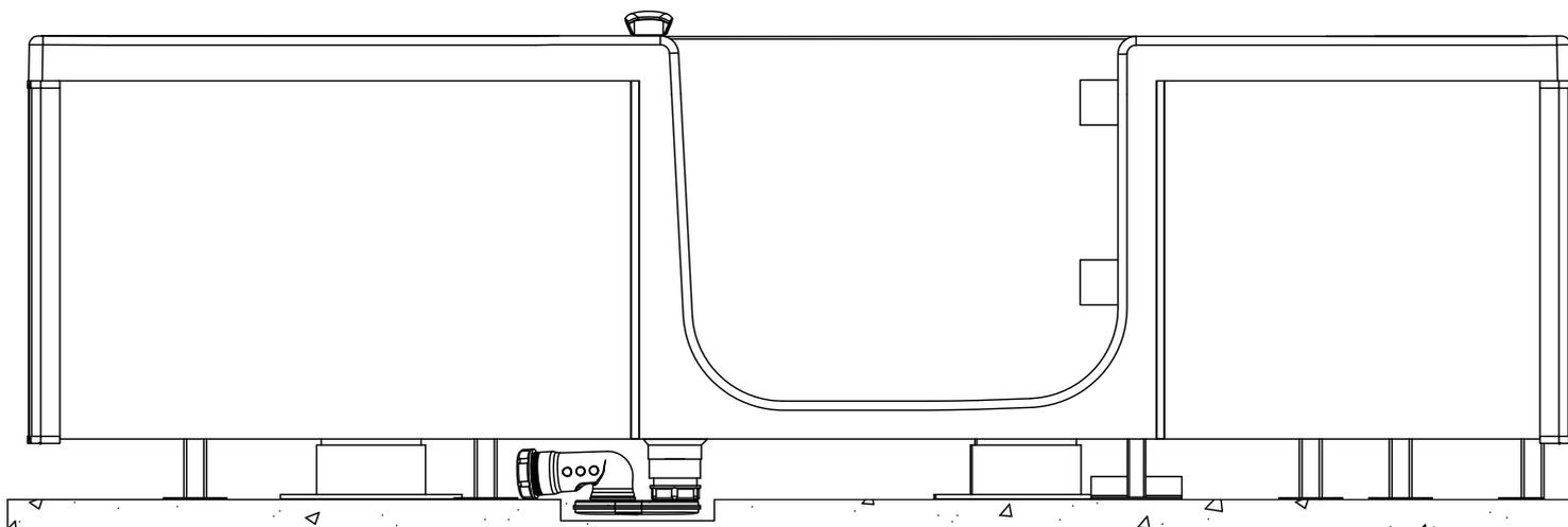
Resserrer les pieds de 10 mm vous permet de réduire la hauteur d'installation.
