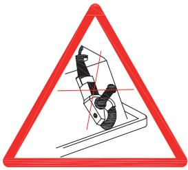
La baignoire ne doit subir aucune modification (sciage, meulage de renfort, déplacement de pompe ...) autre que le perçage pour robinetterie
