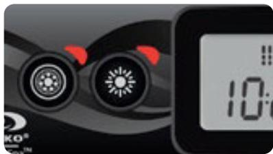
Appuyez sur la touche **Pompe 1** pour démarrer la pompe n° 1 à basse vitesse. Appuyez une deuxième fois pour faire passer la pompe en haute vitesse (dans le cas d'une pompe à deux vitesses\*). Une troisième pression met la pompe à l'arrêt. Une minuterie intégrée arrête la pompe automatiquement après 20 minutes, à moins qu'elle n'ait été éteinte manuellement.
