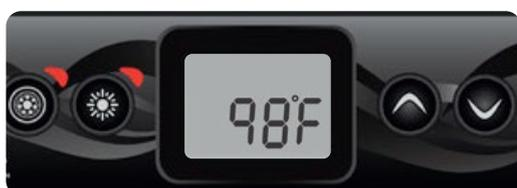
La température affichée en haut de l'écran indique la température actuelle de l'eau. Utilisez les boutons Haut et Bas pour régler la température souhaitée. La valeur de consigne s'affiche en bleu dans le bas de l'écran. Le clavier revient à l'affichage normal des messages après 3 secondes passées sans réglage.
