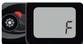
La température de l'eau peut être affichée soit en degrés Celsius (°C), soit en degrés Fahrenheit (°F). L'écran affichera C ou F. Utilisez la touche **Haut/Bas** pour modifier le réglage. Utilisez la touche Lumière pour sauvegarder tous les paramètres.
