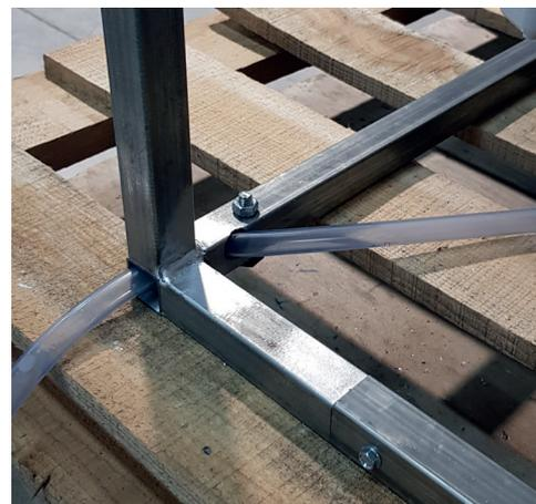
Raccourcir l'angle shape du tablier de 10 à 15 mm afin de pouvoir laisser passer le câble d'alimentation et le kit d'évacuation d'eau.
