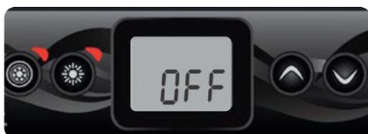
Le mode pause est activé en appuyant pendant 5 secondes sur le bouton de la pompe 1. Ce mode vous permet d'arrêter toutes les sorties, y compris les fonctions automatiques comme le cycle de filtration, les demandes de chauffage et le Smart Winter Mode pendant 30 minutes afin d'effectuer un entretien
